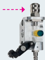
Schritt 1: Draht einfädeln
