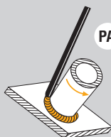
Rohr: Achse: rotierend geneigt PA ASME: 1FR
