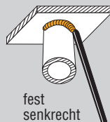
Rohr: Achse: fest senkrecht PD ASME: 4F
