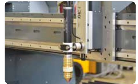
Präzise Abstandsregelung | Precise height control
